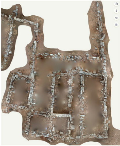
Fig. 24a. Merkezi liman yapılarının mobil lidar kullanılarak taranması ve belgelenmesi
